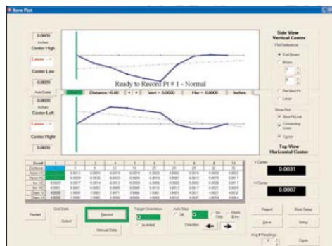
Bore8 Software che mostra un grafico di rettilineità in una Alesatura.
